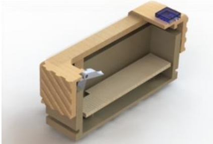
圖 3. 穿脫鞋輔助裝置立體圖(剖面)
