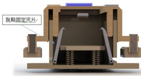
圖 5. 穿脫鞋輔助裝置前視圖(剖面)
