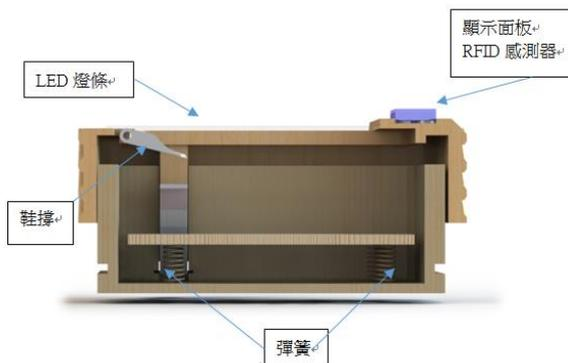
圖 4. 穿脫鞋輔助裝置右側視圖(剖面)
