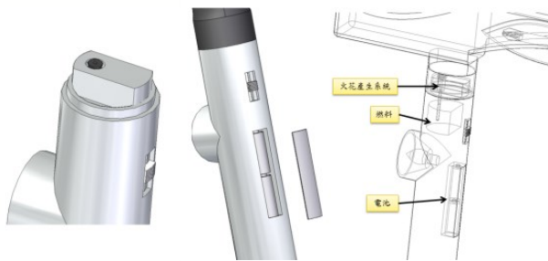
圖 15. 打火機燃料室、登山杖杖身、手電筒握柄整合圖
