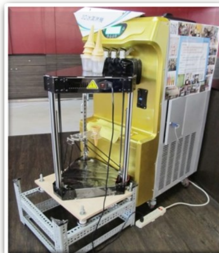
圖 6. 第三代紅外線感應投幣式自動化冰淇淋機 資料來源：健行科技大學 (2016)
